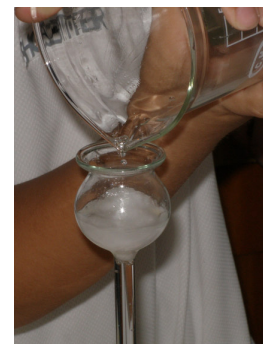
改良後以棉花取代濾紙，薊頭漏斗取代一般漏斗，加速過濾的速度。
