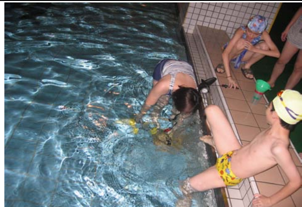
水中的發射點愈深時，水箭噴嘴固定在發射架上時，箭頭向上浮的情形愈嚴重，浮力相當大，爲了操作的安全性，僅做到水深 60 公分。
