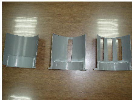
(a) 三種傘形面板；無空洞、單一空洞、三個空洞
