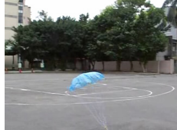
圖 15. 不同材質、形狀及空洞式降落傘及其在空中飛行的連續圖片
