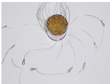
圖 19. 結繩各有專用結繩孔，尾端以端子固定，可使各結繩不易打結。
