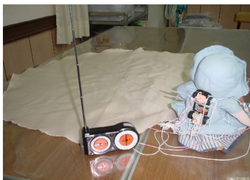
圖 17. 結合遙控車控制輪軸和降落傘結繩形成“遙控式降落傘”。
