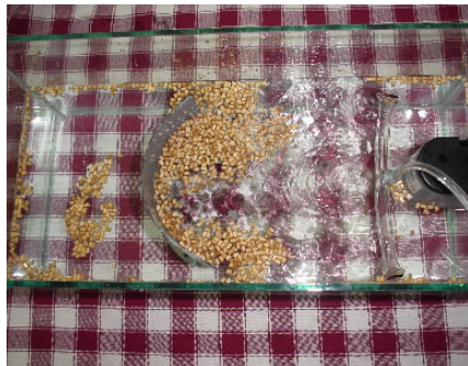
圖 11. (a) 無空洞面板：木屑分布情形
