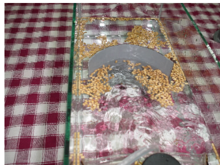
圖 11. (a) 無空洞面板：木屑分布情形
