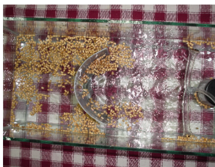
圖 11. (b) 單一空洞面板：木屑分布情形
