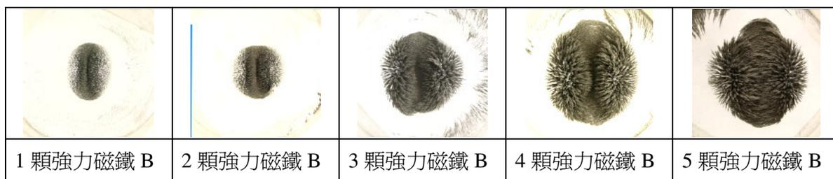
圖九 不同數量的強力磁鐵 B 之側面的磁力線分布情形
