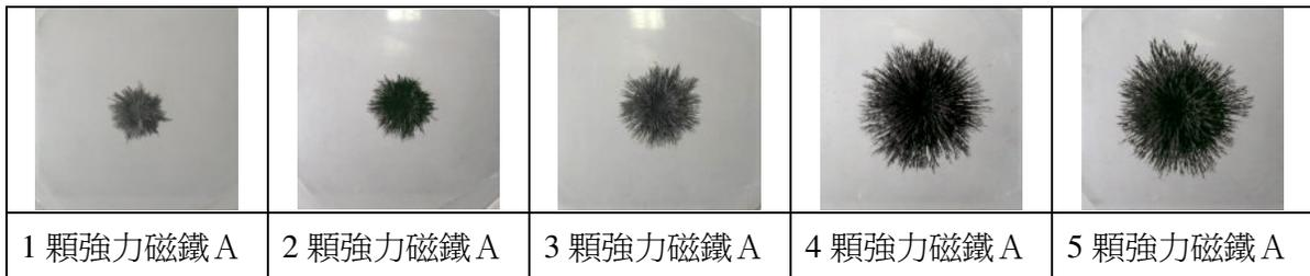
圖六 不同數量的強力磁鐵 A 之磁極正面磁力線分布情形
