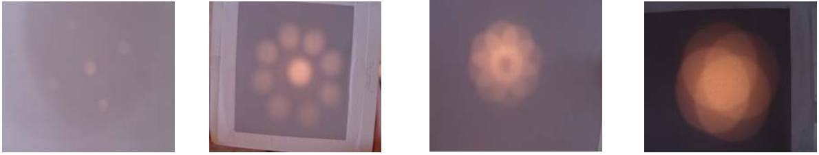
照片 8a：針孔成像 照片 8b：孔半徑 1 公分的成像 照片 8c：孔半徑 2.5 公分的成像 照片 8d：孔半徑 3 公分的成像
