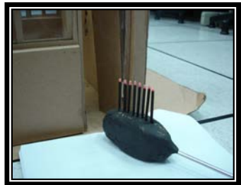
圖 8 點燃線香放入模型
