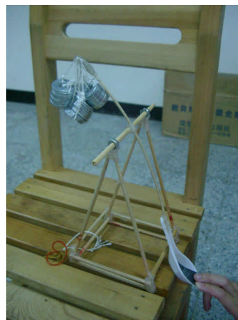
竹籤做的投射桿，掛上四個華司時呈彎曲狀
