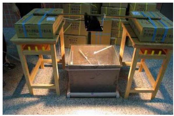
圖五：裝置四，A、B、C、D、為鋼板，F 為玻璃
