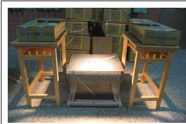
圖二：裝置一，A、B、C、D 為玻璃，F 為鋼板
