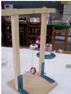
(圖 5)漆包線圈可懸掛在一門字型的支架上。
