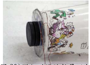
(圖 20)增加磁鐵的數量，測量紙杯耳機音量的變化。
