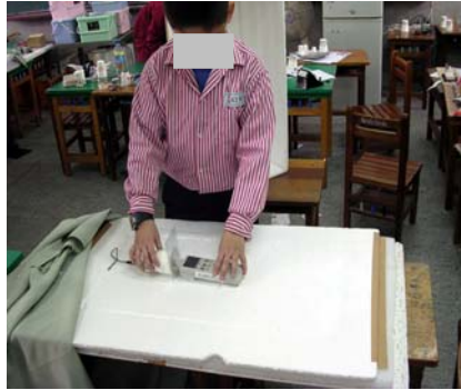
(圖 17)將分貝機放置在紙杯耳機裡的固定位置，以測量聲音的大小。
