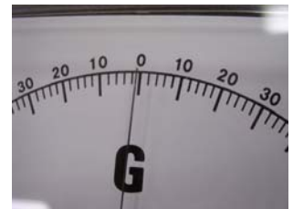
(圖 8)檢流器在音樂撥放時，指針產生輕微的振動。
