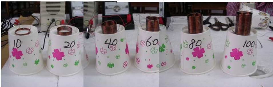
(圖 29)不同漆包線圈數的實驗(不重疊纏繞法)
