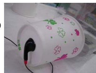
(圖 33) 耳機裝在紙杯杯底測得的音量為 81.7 分貝。
