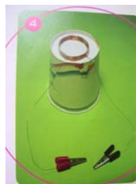
(圖 3) 將線圈以快乾膠固定在紙杯底部中央，兩端接上鱷魚夾。
