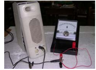
(圖 9)音源線插在接喇叭上，檢流器的指針發生明顯的振動。
