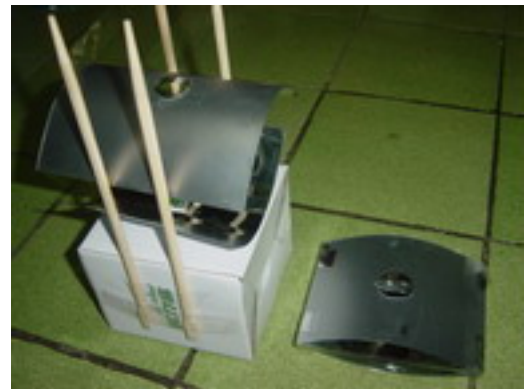
用紙盒、筷子做成改良式可控制上下凹面哈哈鏡間距離的裝置。
