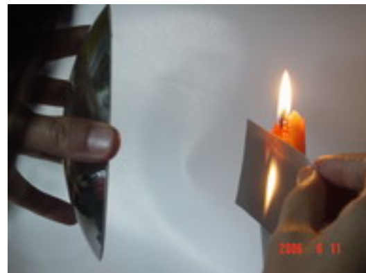
運用物、像一樣大時，鏡到物距離為兩倍焦距，量出距離除以 2 找焦距
