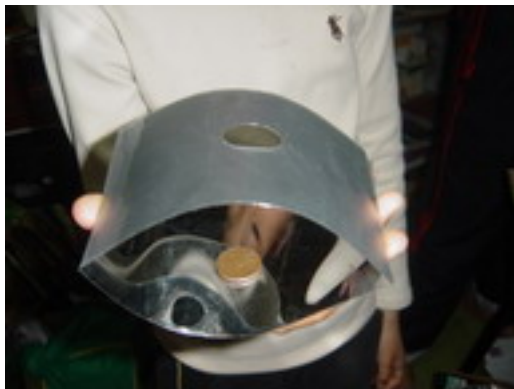
用可彎曲鏡面做成凹面哈哈鏡組合，可找到成像，但沒有剛好在洞口，而是在較低的地方。
