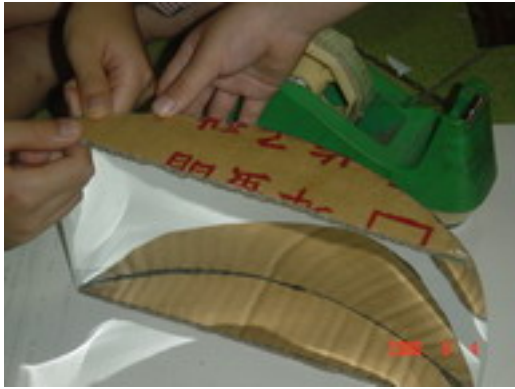
將反光片沿拋物線厚紙板貼好，以改進凹面哈哈鏡的彎曲度
