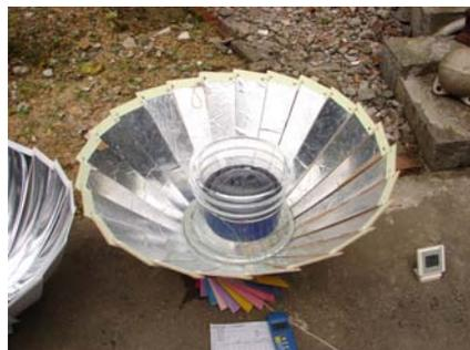
圖 26：太陽光照射聚熱試驗
