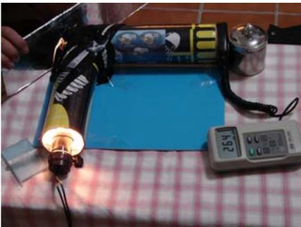
圖 9：自黏式鋁箔反射板測試
