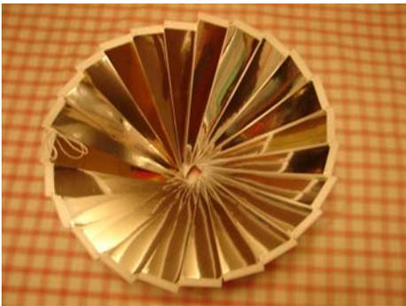
圖 31：PE 鏡面板組成之爐具
