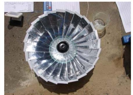
圖 33：鋁箔膠帶組成之爐具
