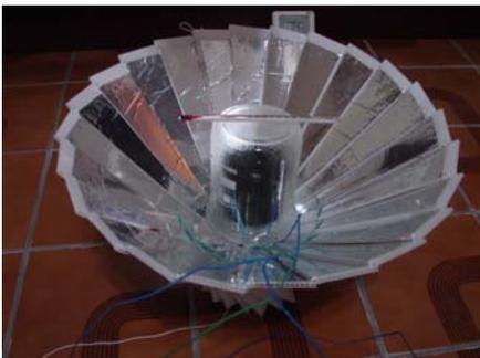
圖 12：鍋具選用測試--黑色鋼杯
