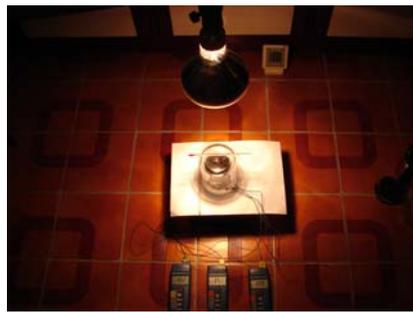
圖 23：有玻璃罩不鏽鋼杯保溫測試
