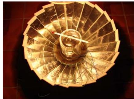
圖 13：鍋具選用測試—淺色不鏽鋼杯
