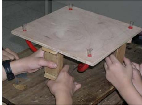
步驟 10-旋轉大螺絲調整高度，使四端水面和檯面一樣高。
