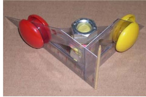
步驟 7-避免被風吹走增加重量，先後使用磁鐵、膠泥、螺帽，一直到秋風吹不動為止。
