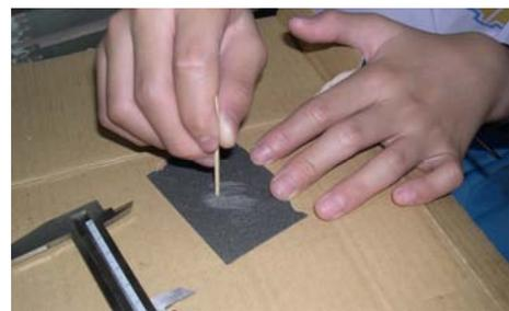
步驟 3-用細砂紙輕磨牙籤，磨去多餘的長度，
