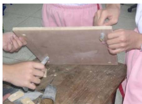
步驟 2-用砂紙磨孔的邊緣，直到透明軟管可以穿入爲止。
