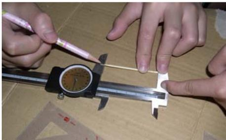
步驟 2-用游標卡尺反覆測量及修正牙籤長度。
