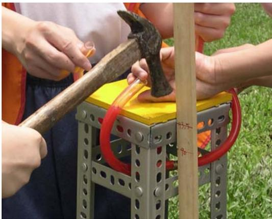
(1) 應用連通管原理，判斷「固定板」是否水平，鐵鎚調整「腳架」高度。
