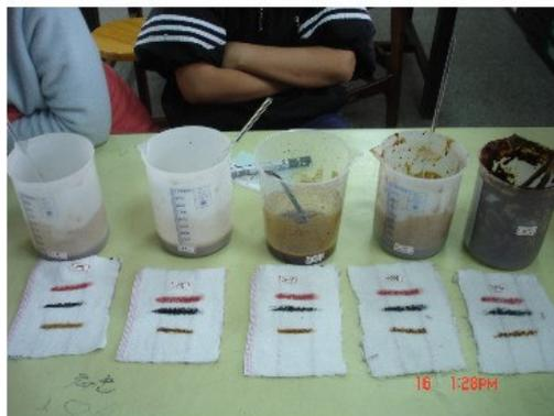
準備做不同濃度苦茶粉溶液的去污力測試
