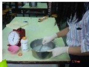
將50ml的NaOH與100ml的蒸餾水混合
