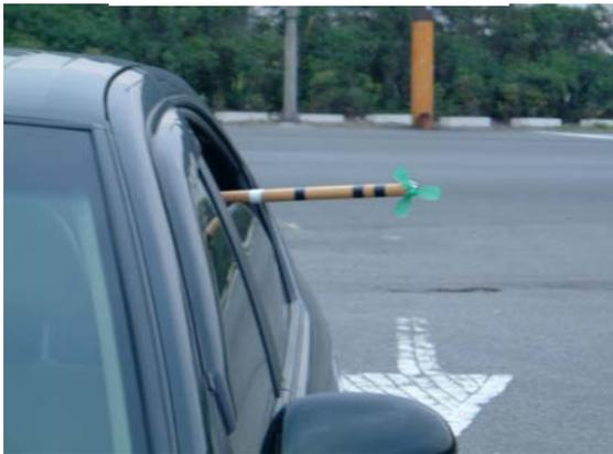
將風速計伸出車外測電壓三次
