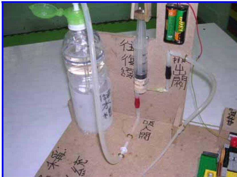
圖片一 圖中右側針筒為往復泵，由針筒改造後可以進水排水的裝置，圖中左側寶特瓶為儲水槽
