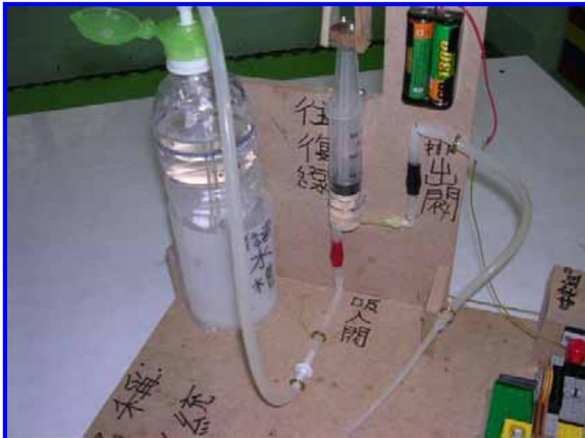
圖片十二 改造後的針筒，針筒下方紅色電夾套是進水閥門，針筒右側黑色電夾套是出水閥門，並且利用機械裝置拉動針筒中的活塞，進水閥門利用橡膠管連接儲水槽。
