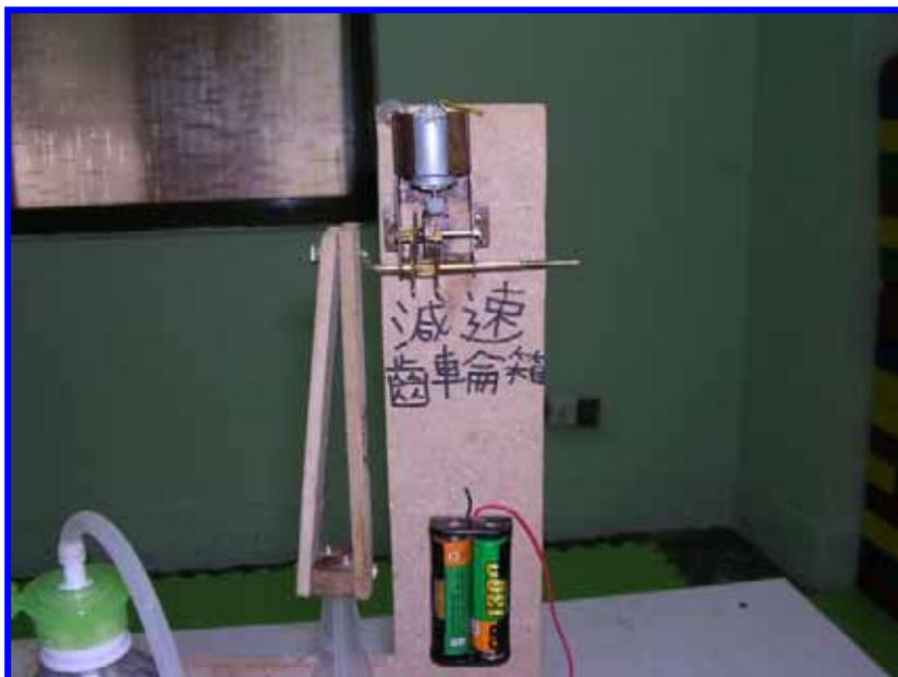
圖片十三 圖中上方的金屬齒輪箱，共有八個齒輪，構成四組齒輪組，每一組都是藉由小齒輪帶動大齒輪，所以都是減速齒輪組，雖然轉速慢，卻可以產生強大的轉動力，並將動力傳遞到最後的軸上，並將這根軸彎成『曲柄』，在針筒活塞桿上方的兩個木條，就是『連桿』，連桿可以將『曲柄和活塞桿』連接起來。自製的噴水裝置就可以運作了。
