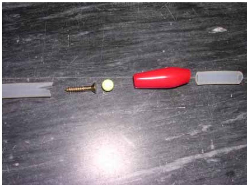
圖片十 進水和排水閥門的完整構造圖，BB 彈和螺絲放入紅色電夾套中，前方套上倒 V 字形橡膠軟管，後方套上一段軟管，就完成了防止流體逆流的裝置。當螺絲被吸入倒 V 字形軟管時，雖然會堵住管子，但是水可以從 V 字形的縫隙中流入，BB 彈則是用來堵住下方軟管。
