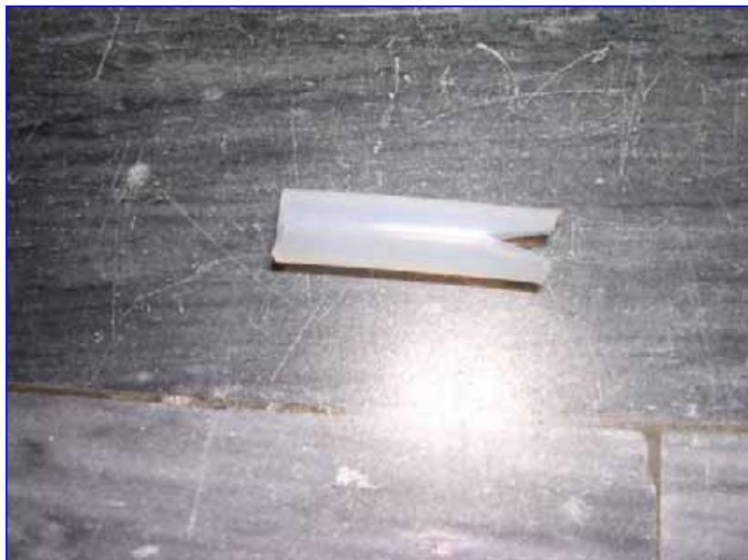
圖片九 進水閥門和排水閥門上方的橡膠管，剪成倒 V 字形是為了方便進水
