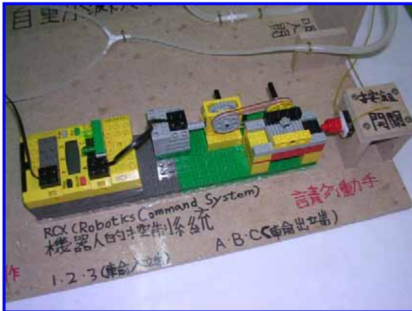
圖片十五 圖片中左側的黃色盒子是〈RCX〉它是一個可以接受程式、處理程式和執行程式的控制盒，RCX 上最左邊的電線連接的是溫度感應器，右邊的電線連接的是馬達，在溫度感應器偵測到設定的失火溫度後，RCX 就會啓動馬達帶動機械裝置去觸壓圖中最右邊的紅色按鈕開關，開關壓下後，往復泵就會開始抽水滅火。
