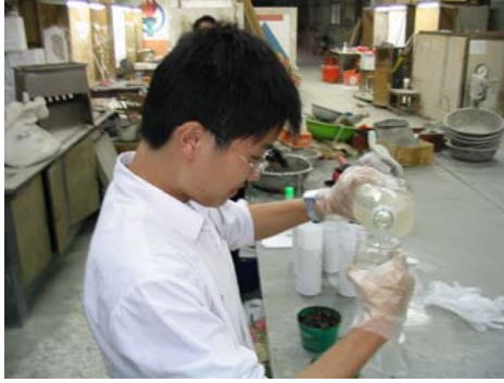
圖 7 量取水玻璃用量
