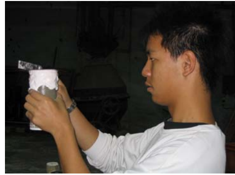
圖 13 抗壓試體蓋平
