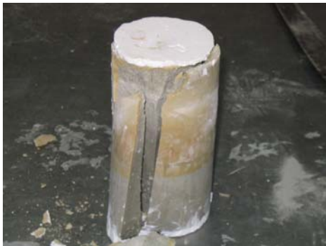
圖 14 試體之破壞情況
