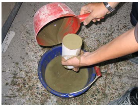
圖 11 灌製抗壓試體
