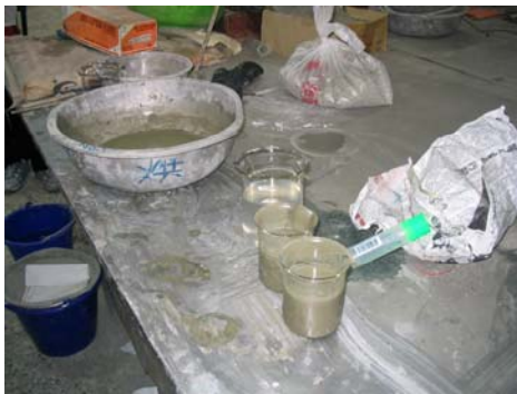
圖 9 水泥漿與水玻璃溶液
