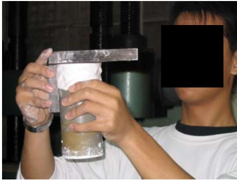
圖 13 抗壓試體蓋平
