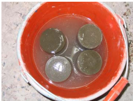
圖 12 抗壓試體養護
