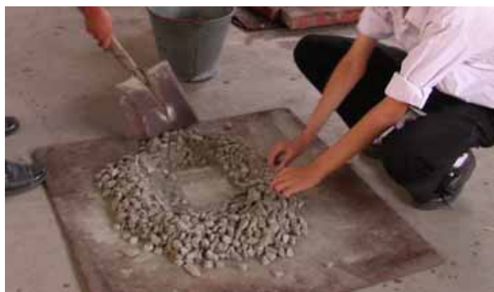
圖 3-1 拌和無細骨材混凝土過程
