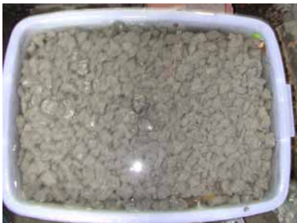
圖 4-6 無細骨材混凝土鋪面
