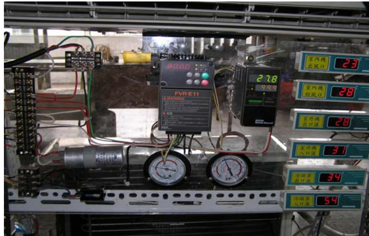
(圖 9) 變頻器連接電路示意板
