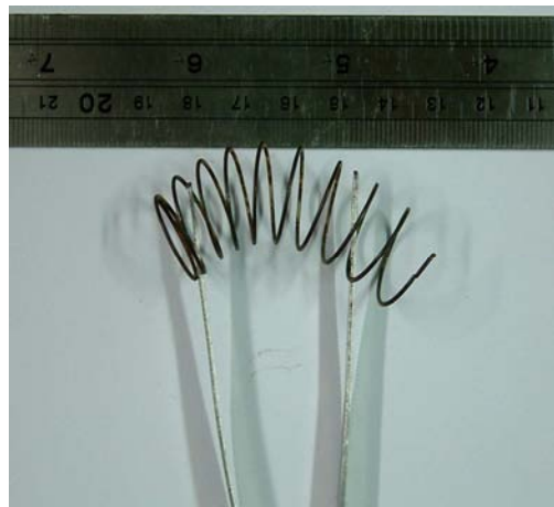
以小彈簧來模擬實際彈簧的彎曲度(兩爪式)
