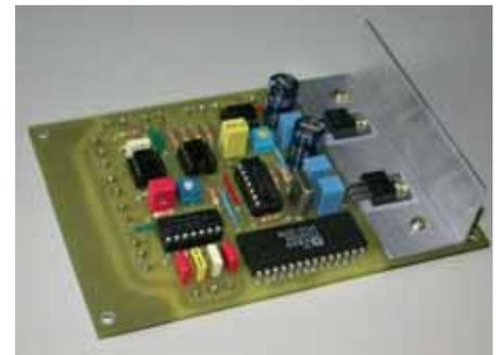
圖 12-3 零件測試儀電路板
