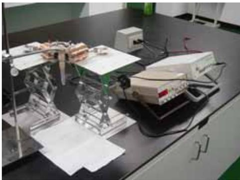
圖 18-1 電磁鐵與可自由振盪之平板
