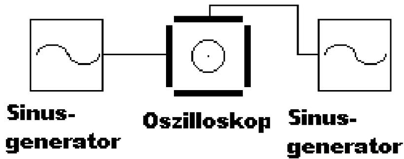
圖 6 兩台訊號產生器繪出雙軸諧振示意圖
