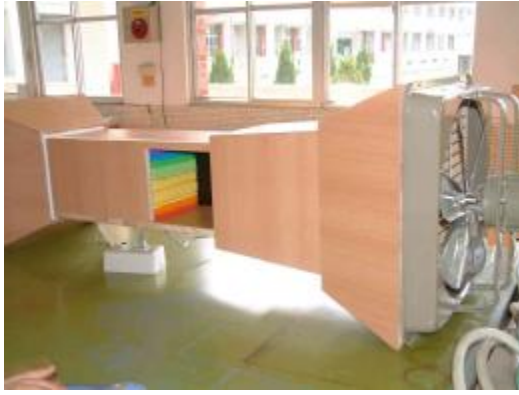
圖四 自製之風洞裝置
