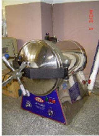
(圖) 高溫高壓滅菌機
