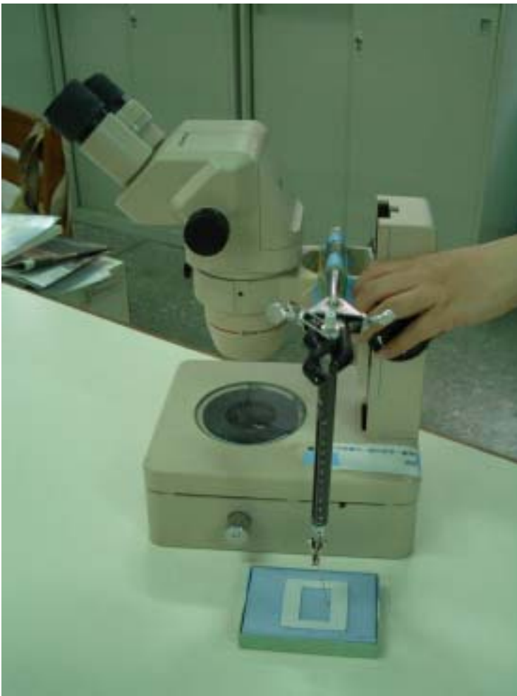
圖六、張力測試裝置。
