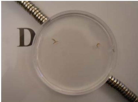
↑ (1) 培養皿兩端各放置 N、S 極
