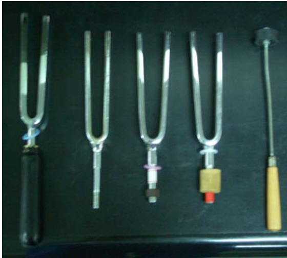
圖 1 定音音叉 (頻率固定)
