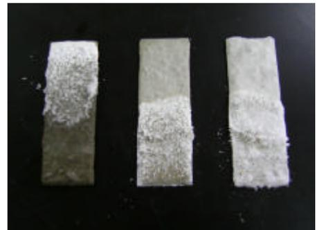
八、實驗 8 中，於 20 克的混凝土結構裡添加約 0.2 克的肥皂絲(硬脂酸鈉)，發現幾乎能完全抑制試體中水的滲入與毛細上升現象(圖十五)，因而有效防止白華的生成。推論肥皂絲防癌關鍵的因素如下：
