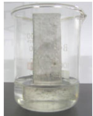
►圖十五：添加硬脂酸鈉的試體不見滲水跡象
