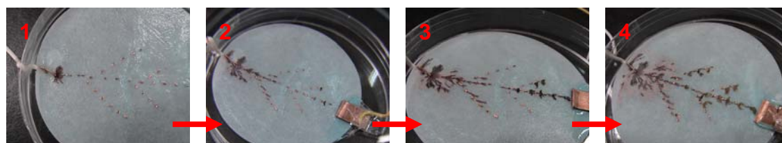
【圖 2】電解時金屬樹生長過程
