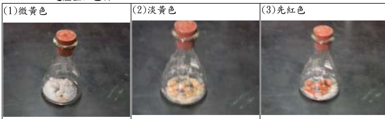
圖.4  $\text{Pb}(\text{CH}_3\text{COO})_2 \cdot 3\text{H}_2\text{O}(\text{s})$  加入  $\text{NaOH}(\text{s})$  表面物顏色變化過程。
