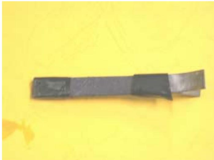
圖. 22 化成後生成灰色 Pb 電極
