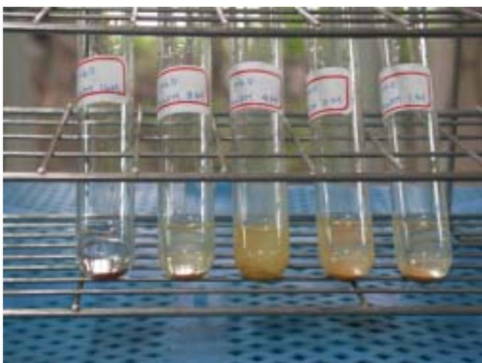
圖. 3 不同 NaOH<sub>(aq)</sub> 濃度下, 產生紅色沉澱物的情形
