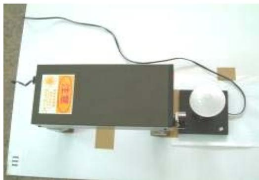
圖十二 雷射光通過燈泡偏折實驗裝置
