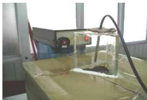
圖四 加熱空心的玻璃稜鏡測量偏角
