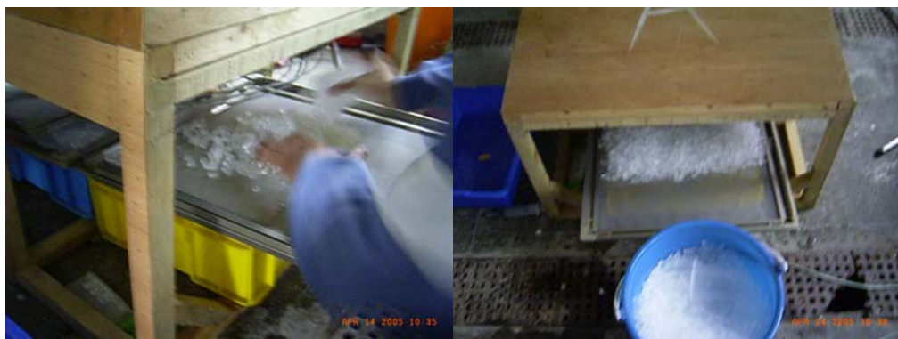
風洞內部降溫設備
