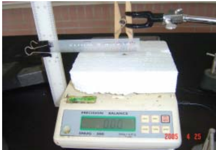
圖五：測量小磁鐵質量及小磁鐵之磁偶極矩的實驗裝置
