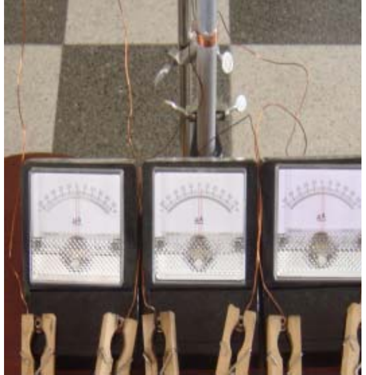
圖六：測量小磁鐵在金屬管內的終端速率之實驗裝置。左上圖為裝置側面，右上圖為裝置正面。
