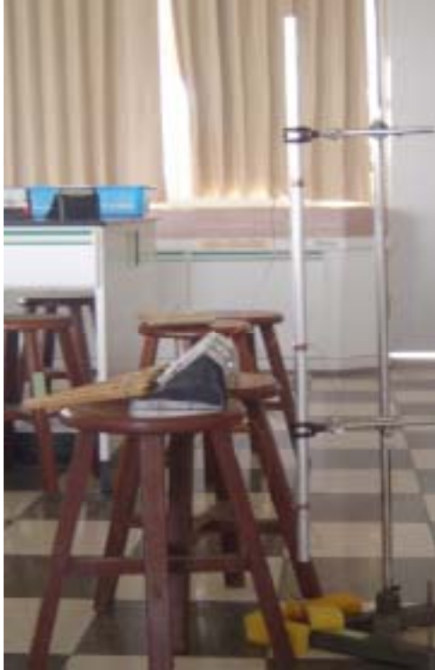
圖六：測量小磁鐵在金屬管內的終端速率之實驗裝置。左上圖為裝置側面，右上圖為裝置正面。
