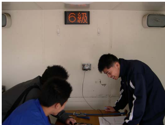
圖 5-8 地震感測器裝置於牆壁之比較實驗
