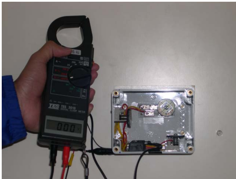
圖 5-6 檢測地震是否達到設定震度之接線照片
