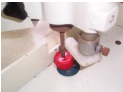
照片六、利用鑽孔機在瓶蓋上打洞
