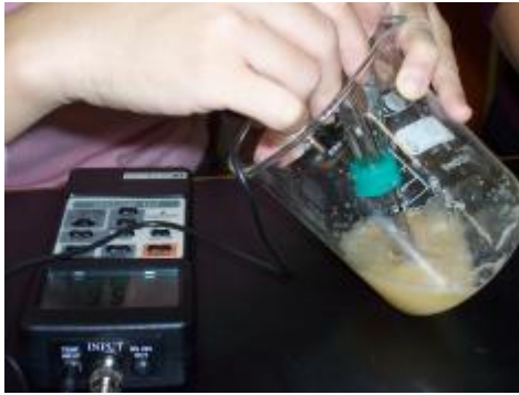
照片三、利用 pH 儀測量溶液的酸鹼性
