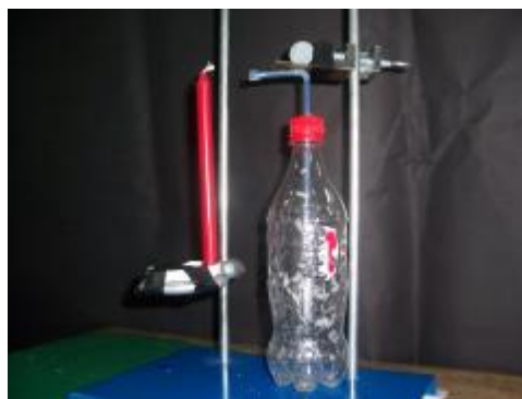
照片九、用來固定簡易滅火器和蠟燭的固定架
