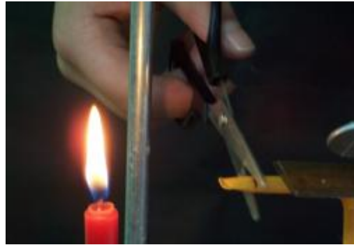
照片十一、從黑線位置剪開噴嘴後迅速移開剪刀
