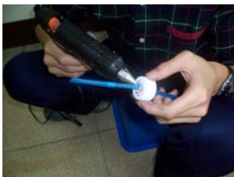
照片八、用熱熔膠填滿吸管和瓶蓋間的空隙
