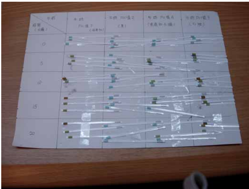
圖 5-1 添加乳糖酶於模擬消化系統中不同酸鹼值之牛乳中在不同的時間所觀察到尿糖試紙上顯現的顏色
