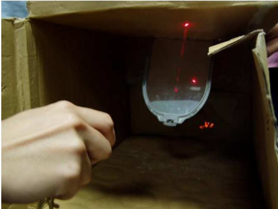
正面觀察雷射光照射防眩光板的折射與反射
