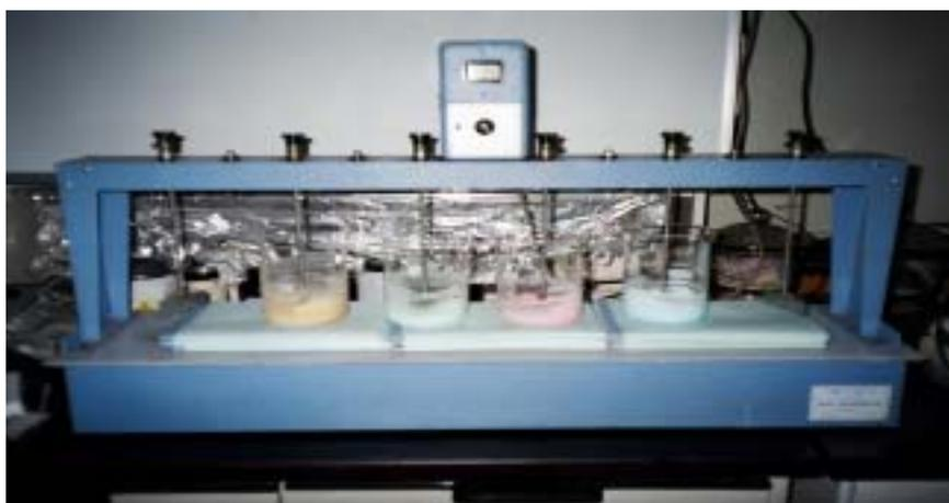
照片三 觸媒製作-攪拌含浸觸媒
