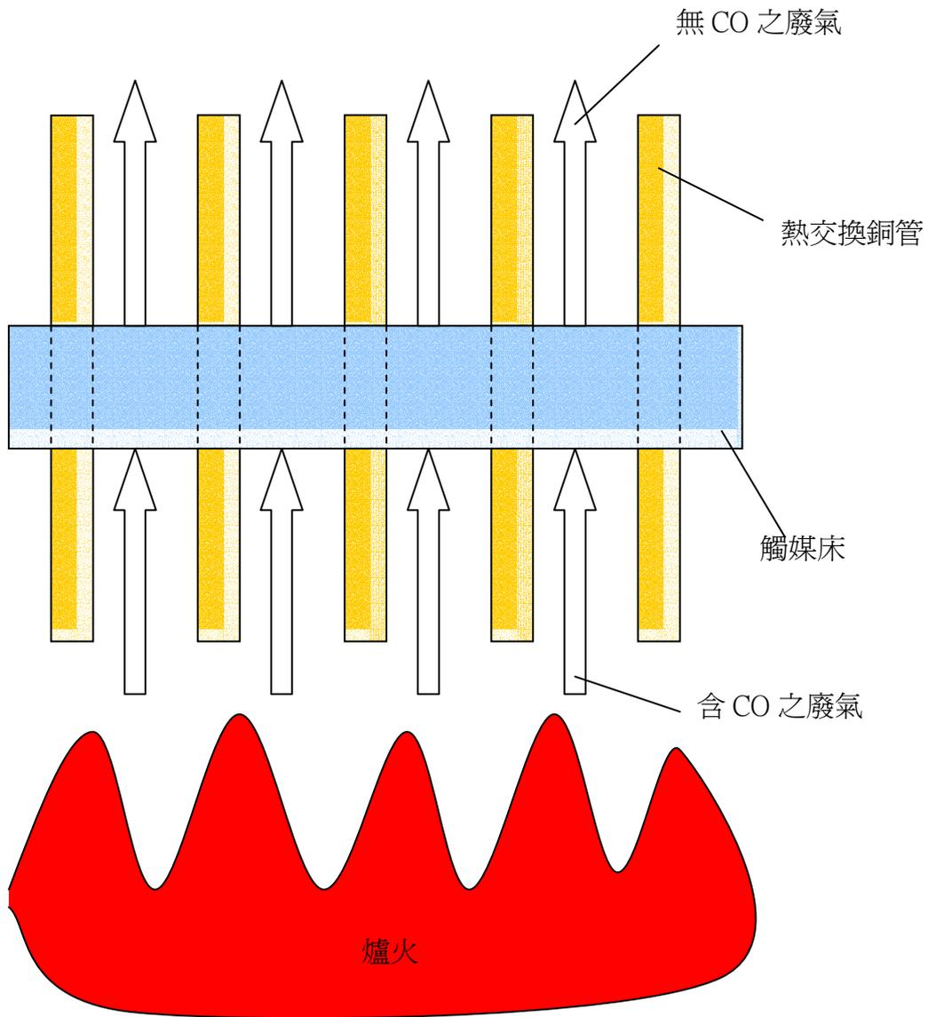
圖一 瓦斯熱水爐觸媒轉化器示意圖
