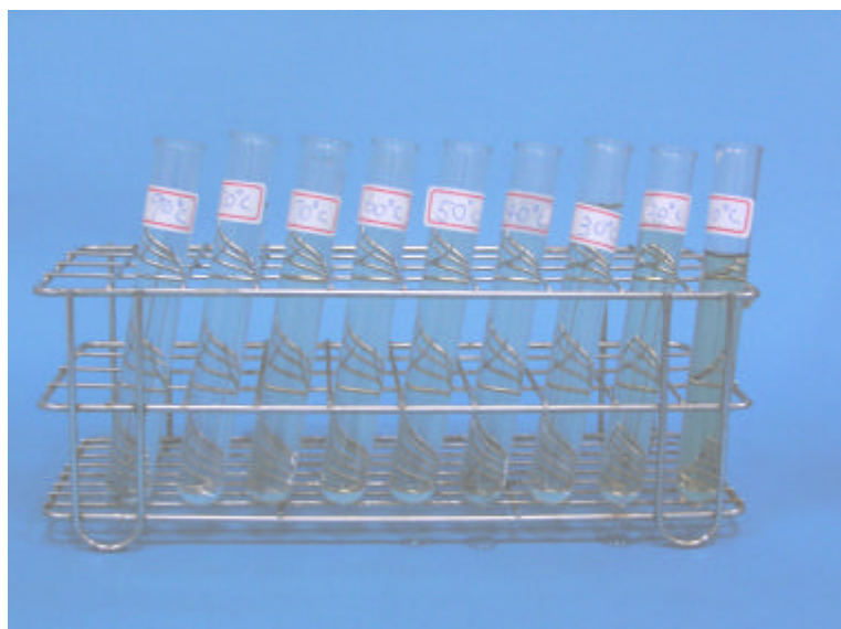
圖二十一 不同溫度的溶液對活性炭脫色影響的照片
