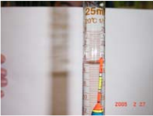
(附圖八) 蔗糖百分濃度 0 % 的標準溶液(上升 0mm)
