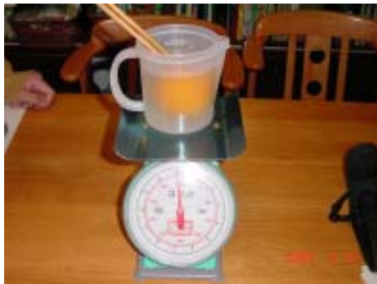
(附圖二) (附圖三) 以排水法測量柳丁體積(因柳丁密度小於水，須以竹筷壓柳丁，否則會浮起來)
