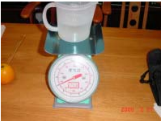
(附圖二) (附圖三) 以排水法測量柳丁體積(因柳丁密度小於水，須以竹筷壓柳丁，否則會浮起來)
