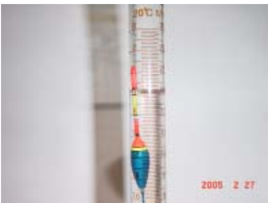
(附圖十) 蔗糖百分濃度 10 % 的標準溶液(上升 13mm)
