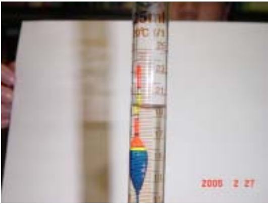
(附圖十一) 蔗糖百分濃度 15 % 的標準溶液(上升 19mm)
