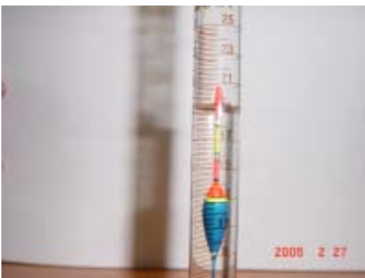
(附圖九) 蔗糖百分濃度 5 % 的標準溶液(上升 7mm)
