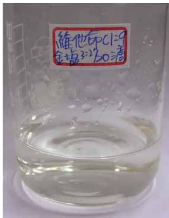
↗圖 (十)、25°C 15 滴維他命 C 溶液 (1:9)，反應時間 25 分鐘
