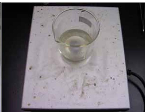
↑圖 (五)、攪拌中的  $\text{HAuCl}_4$  溶液
