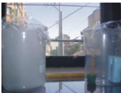
圖十九 點燃的線香除煙效果 (左為不加負離子的對照組， 右為加入負離子的實驗組，點燃時間3分鐘)
