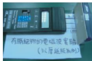
圖十一 有隔絕物的電磁波 實驗(以厚紙板為例)
