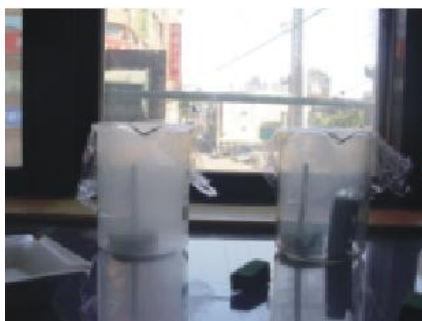
圖二十 點燃的香菸除煙效果 (左為不加負離子的對照組， 右為加入負離子的實驗組，點燃時間3分鐘)
