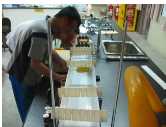
圖 5-8 使用水平儀調整水道坡度
