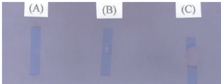
圖十一：氯化亞鈷試紙與口紅膠(A)、快乾膠(B)、膠水(C)之反應，(A)呈藍色，(B)(C)呈粉紅色。
