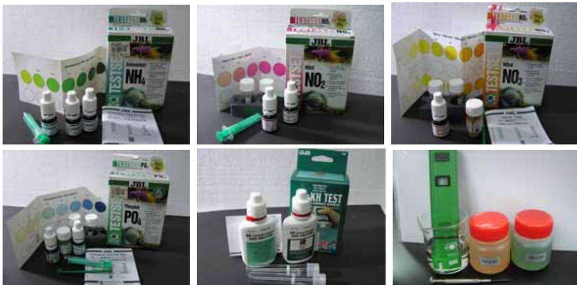
利用 JBL 氨、亞硝酸、硝酸、磷酸檢驗試劑套組及魚柏士 GH/KH 總硬度與檢驗試劑套組，依說明書指示於採樣水中添加呈色反應藥粉與溶液，待呈色後，以說明書上所附比色紙盤，進行比對，推測濃度。以 pH 儀測定 pH 值，並紀錄溫度。
