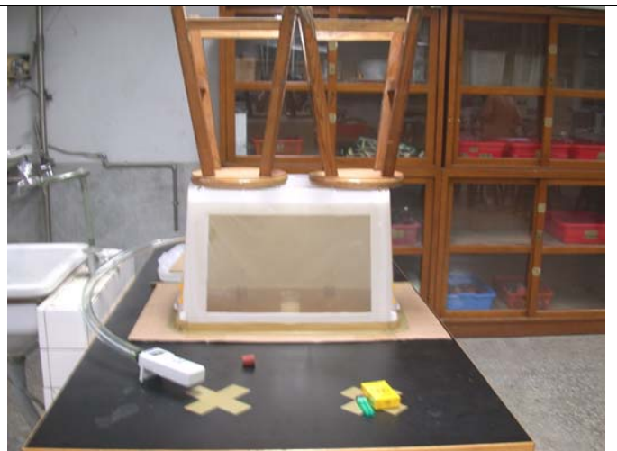
照片十八、檸檬原汁在「較高 CO 含量的密閉空間中」去除 CO 的效果實驗。 (實驗進行中)
