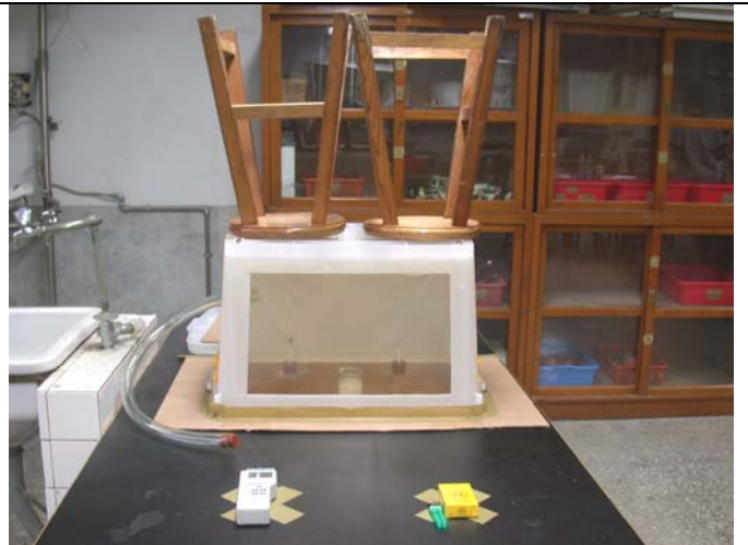
照片十五、檸檬原汁在「較高 CO 含量的密閉空間中」去除 CO 的效果實驗。 (實驗進行中)
