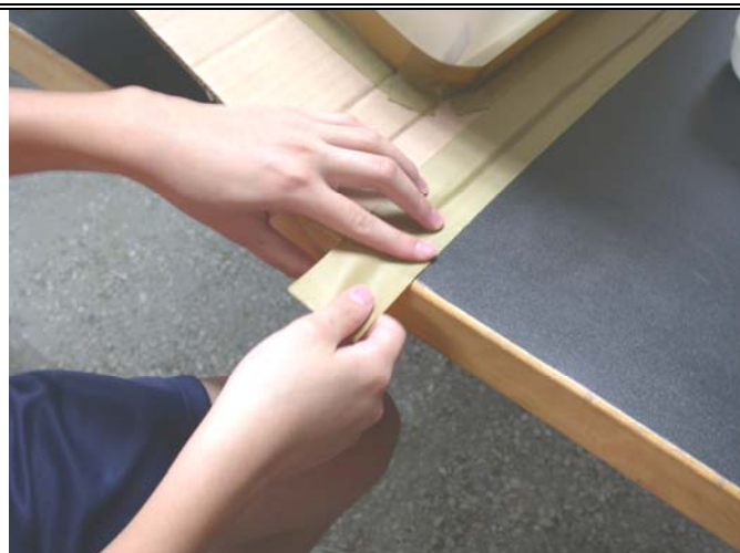
照片二、用膠帶封住實驗裝置與桌上的縫隙，避免一氧化碳外漏。
