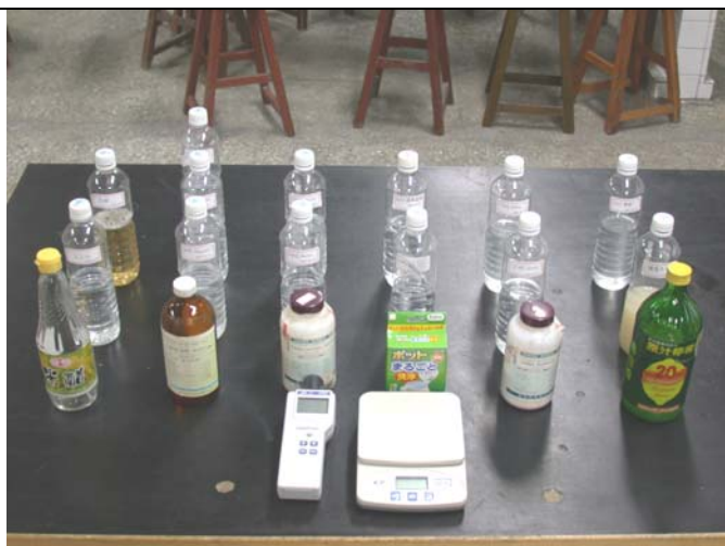
照片五、測試用實驗藥品（由左至右）：糯米醋、醋酸、試藥級碳酸氫鈉、檸檬酸鈉、試藥級碳酸鈉、檸檬汁。
