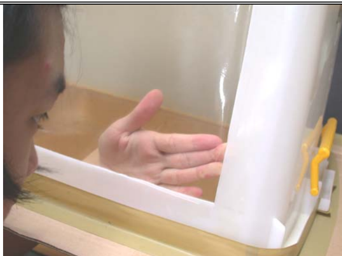
照片一、用透明塑膠膜做觀察視窗，便於觀察密閉空間中實驗進行的情形。
