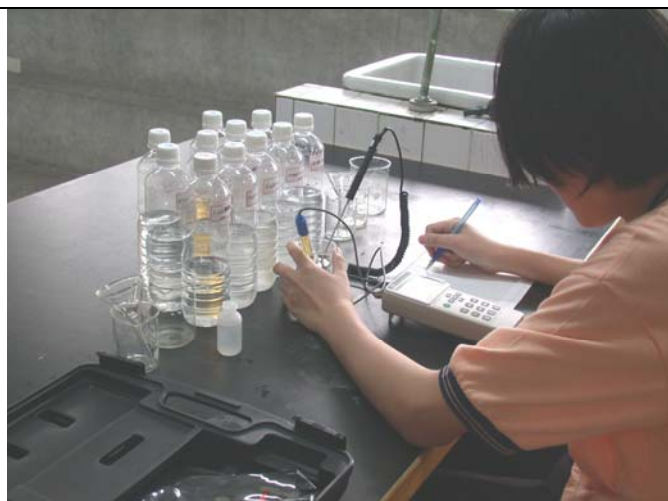
照片四、以 pH 計測量水溶液的酸鹼值。
