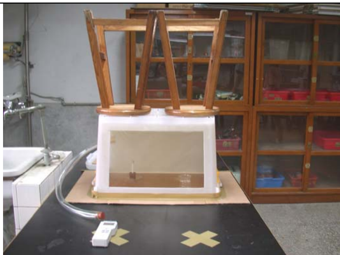
照片九、在收納箱上放置兩張木椅緊壓，確保香菸燃燒時所產生的 CO 氣體不會逸散。
