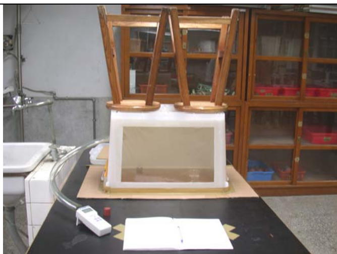
照片十一、每節下課時間持續測量收納箱中 CO 的濃度，直至當日下午 18:00 為止。
