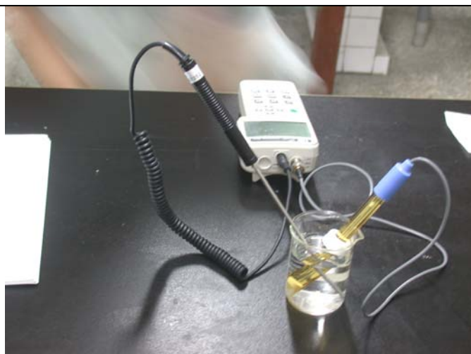
照片十二、每日下午 18:00 放學時，測量「去除 CO 水溶液」的 pH 值。
