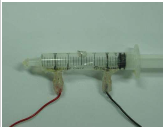
圖四：第一代簡易電解裝置（使用針筒、針頭等材料...）
