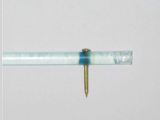
圖八：第二代簡易電解裝置的電解完成狀態（形成直徑約3mm的離子色柱）
