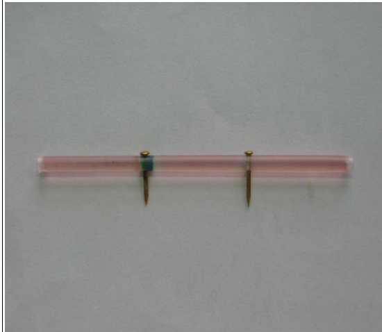
圖十：當通電電壓大於0.7伏特，不只是進行電解反應（形成離子色柱），還會發生電鍍反應。
