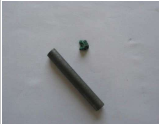
圖二：電解硫酸銅膠水溶液時，在負極附上的氫氧化銅。
