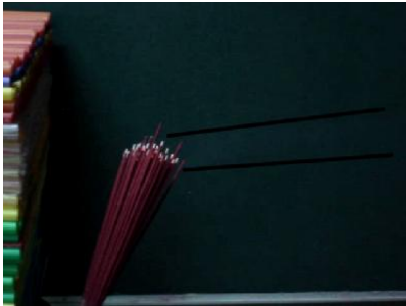
圖<4>：經過整流管後，線香煙霧飄散狀況（煙為平行前進）
