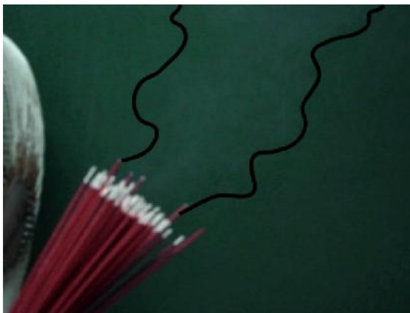
圖<1>未經過整流管，線香煙霧飄散狀況
