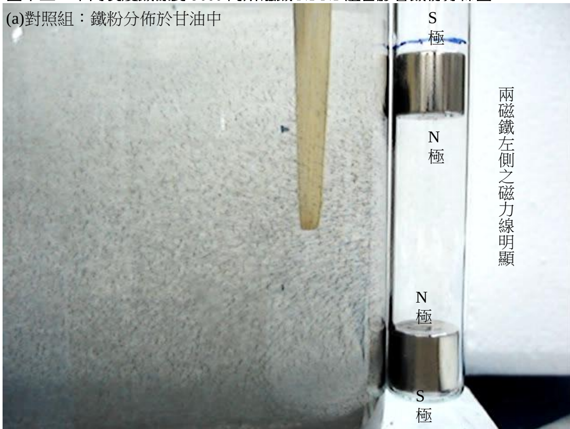
圖十三：不同長度鐵線對 3000 高斯磁鐵 N1-N1 組合影響鐵粉分佈圖
