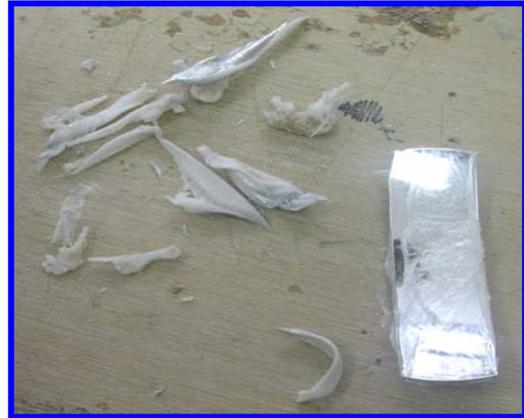
圖 13 車用凸面鏡上所取下的小曲面
