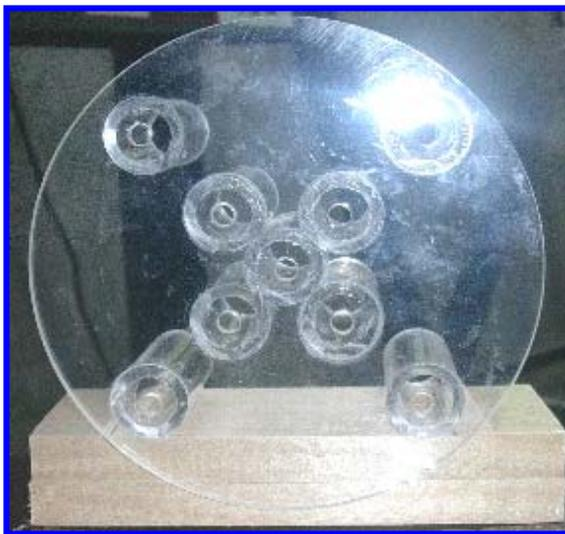
圖 36 自製雷射座，可裝 9 支雷射
