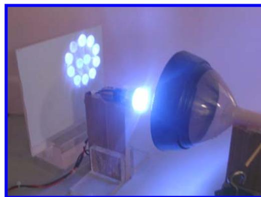
圖 50 自製凹面鏡之成像實驗
