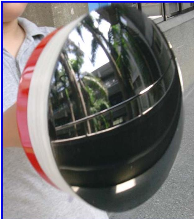
圖 52 以黑色噴膜製成的可調式面鏡
