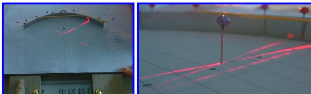
圖 38 利用兩平行雷射光求拋物曲面的焦點
