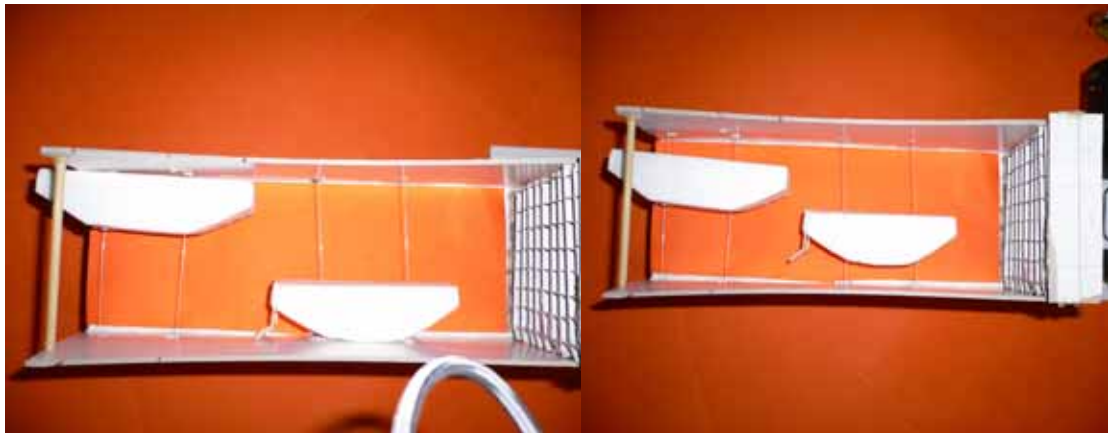
①未開風扇時，有擾流板的在上，無擾流板的在下②風扇啓動，有擾流板的開始下壓，無擾流板的開始上飄
