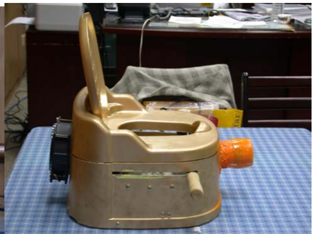
圖十、乾燥式環保免水馬桶一代（側面圖）
